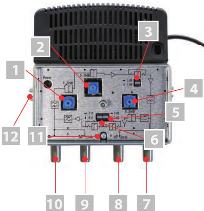
Bild 2: Verstärker HVC 42, Innenansicht
